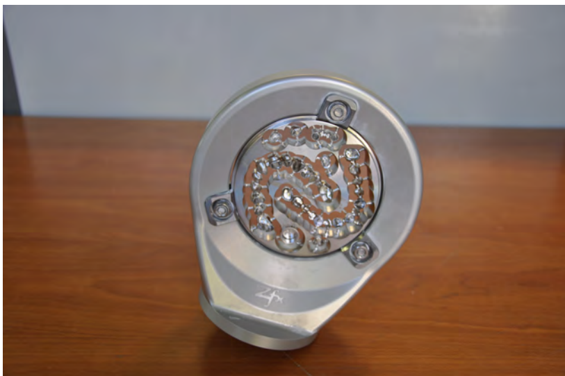
Picture7. Mandril de sujeción de piezas brutas para Zfx™ Inhouse5x Inserción del mandril de sujeción de piezas brutas para la Zfx™ Inhouse5x:
