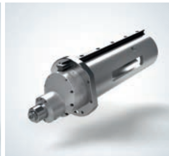
Spindel mit einem Drehzahlbereich von 6.000 min -1 bis 100.000 min -1 (4er-Schaft / Drehmoment: 8,4 Ncm)
